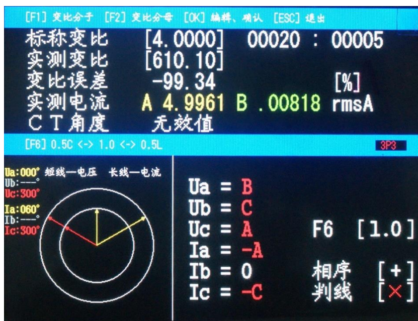
(图 10) 向量图查接线测变比界面
