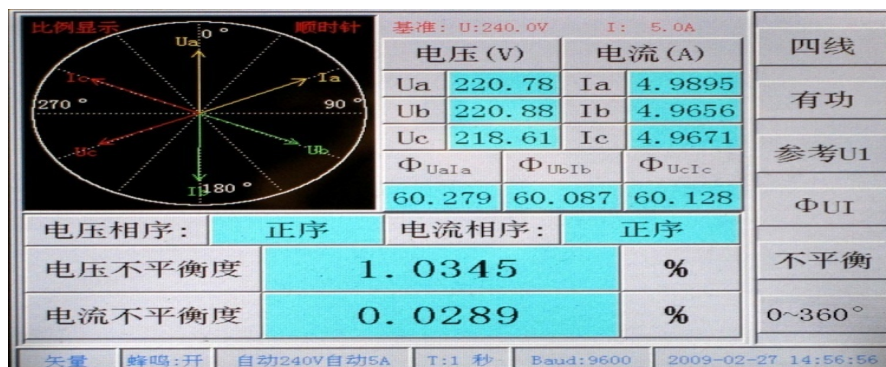
图 6.6.1 三相四线相位、相电压不平衡测量界面
