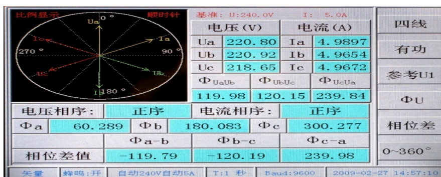
图 6.6.3 三相四线相位、相位差测量界面
