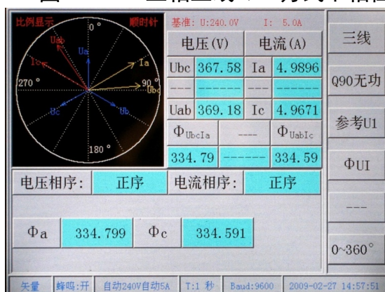
图 6.6.9 三相三线 Q90 方式下相位测量界面
