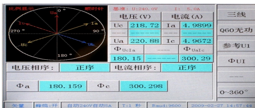
图 6.6.8 三相三线 Q60 方式下相位测量界面
