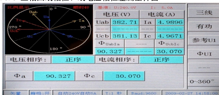
图 6.6.7 三相三线有功方式下相位测量界面
