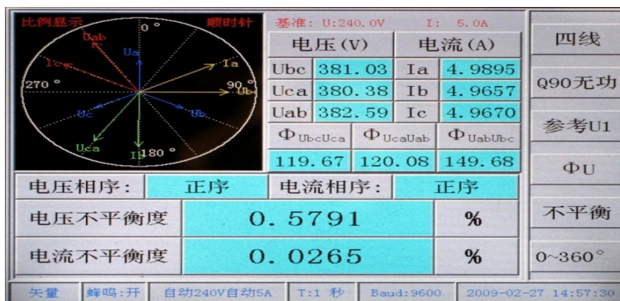
图 6.6.4 三相四线相位、线电压不平衡测量界面
