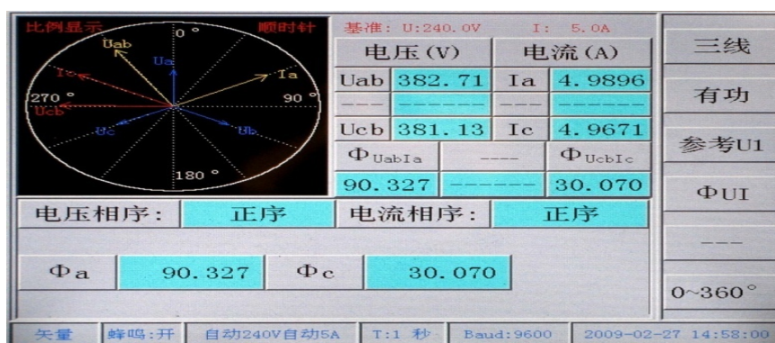
图 6.6.7 三相三线有功方式下相位测量界面
