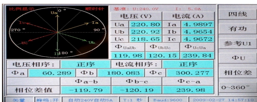
图 6.6.3 三相四线相位、相位差测量界面
