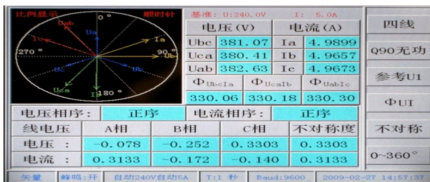
图 6.6.5 三相四线相位、线电压、电流不对称度测量界面
