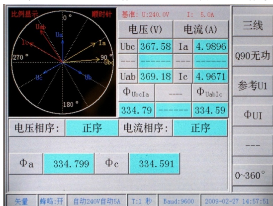
图 6.6.9 三相三线 Q90 方式下相位测量界面
