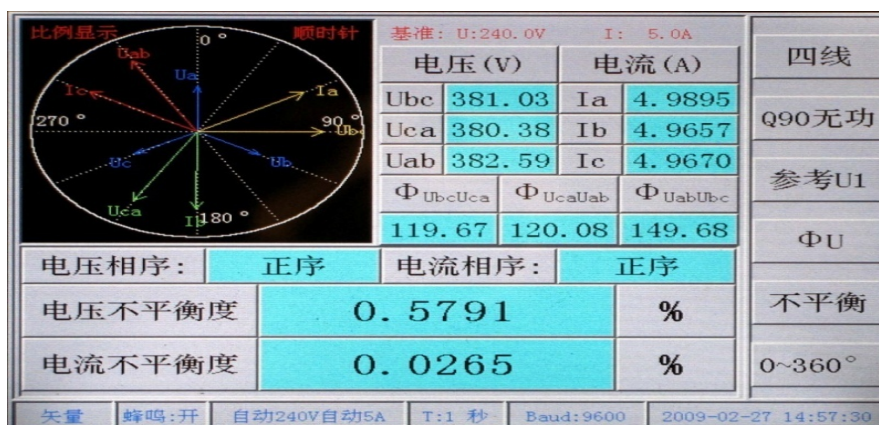
图 6.6.4 三相四线相位、线电压不平衡测量界面
