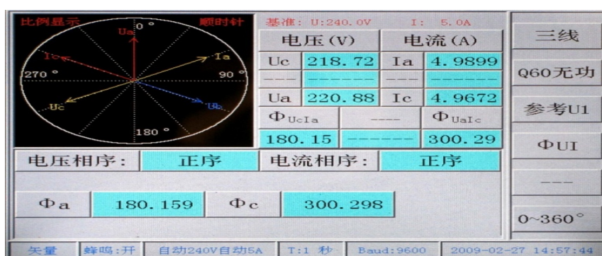
图 6.6.8 三相三线 Q60 方式下相位测量界面
