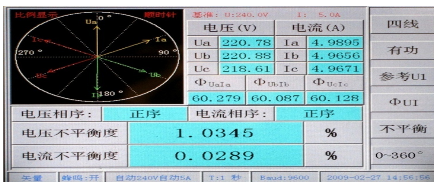
图 6.6.1 三相四线相位、相电压不平衡测量界面
