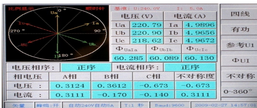
图 6.6.2 三相四线相位、相电压、电流不对称测量界面
