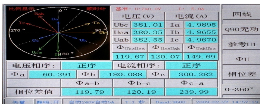
图 6.6.6 三相四线相位、线电压相位差测量界面
