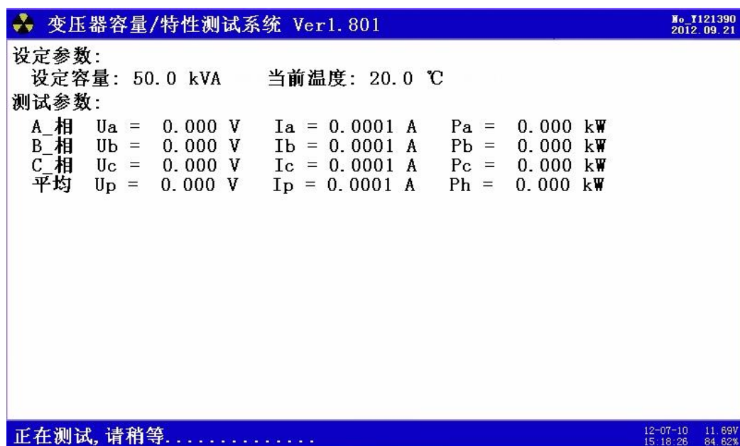
图 10、有源负载测试（进行中）
